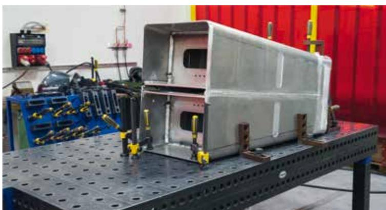
鉄道車両の天蓋と衝突モジュールを製造しています。これらはアルミニウムで出来ており他の部品と同様にSiegmond溶接台を使用して加工や溶接作業がなされています。一通り加工作業が終わりますと車両の組み立てに使用されます。
